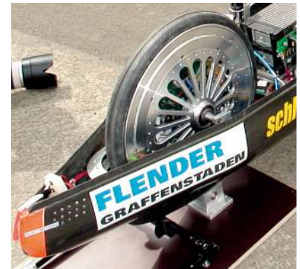
Abb. IV.8.2-2: Fertig gestellter Motor in eingebauten Zustand
