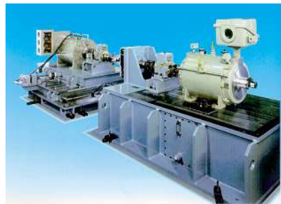
Abb. IV.7-1: Getriebeprüfstand mit Drehstromantrieben zur Verbrennungsmotorsimulation und zur Belastung (Quelle: UNICO Deutschland)
