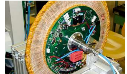
Abb. IV.8.3-2: Die komplette Motorelektronik ist im Inneren der Spule und damit im Inneren der Hinterradfelge angebracht
