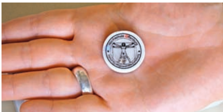
Abb. 1.4-5: \mu Sens, in vergossener Ausführung. Die Abmessungen entsprechen einer 2-Euro-Münze
