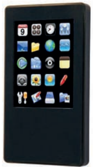
Abb. 1.3-1: PDA mit grafischer Touchscreen-Oberfläche, entwickelt an der Hochschule Offenburg mit dem eigenen Prozessorkern SIRIUS, 32 bit, 48 MHz, ca. 40 MIPS Leistung auf einem programmierbaren Cyclon III FPGA
