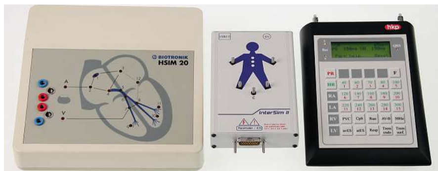
Abb. 1.3-1: Drei elektronische Herzrhythmus simulatoren mit unterschiedlichem Parameterumfang. Von links nach rechts die Geräte HSIM 20 (Biotronik, Berlin), Intersim II (Lang, Chemnitz) und der in diesem Beitrag genutzte ARSI-4 (hkp, Bannewitz) für Ausbildungszwecke und industrielle Simulationen an Herzschrittmachern und Defibrillatoren
