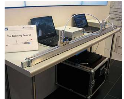
Abb. 2.2-1: „Sprechende Sitzschiene“ – Demonstrator der 3. Generation
