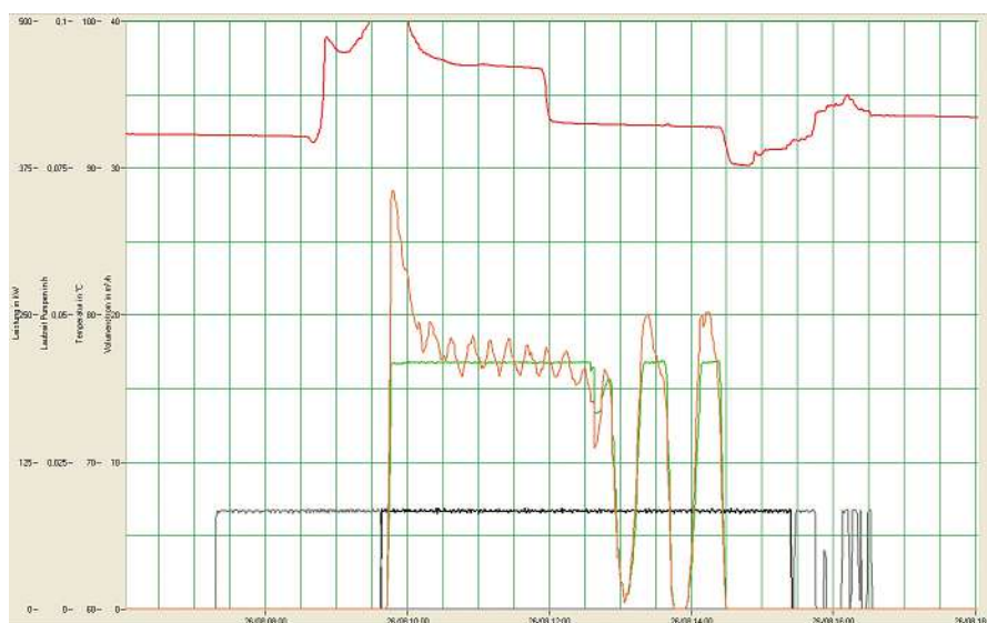
Abb. 3.1-4: Darstellung der Betriebszeiten der Speicherentladepumpen HP3/1 (groß) und HP3/2 (klein), des Speicherentladevolumenstroms VSV, der wie die Speicherentladeleistung (PSV) nur dann erfasst wird, wenn der Bypass zum Heizungssystem geöffnet ist. Es zeigt sich, dass die Pumpen morgens und abends jeweils ca. zwei Stunden ohne Wärmeabgabe die Rohrleitungen warm halten
