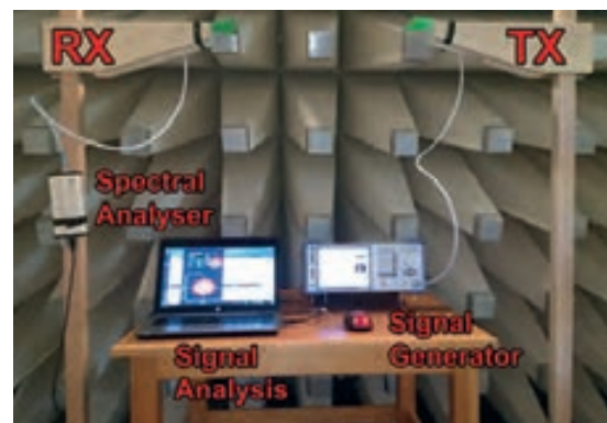
Abb. 2: Testaufbau zur automatischen Modulationsartenbestimmung von Funksignalen
