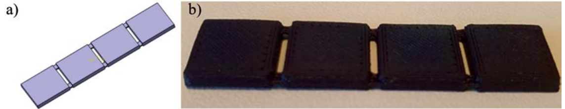
Abb. 1: Zick-Zack-Element in Anlehnung an [6] a) optimierte Geometrie (CAD) und b) optimiertes, gedrucktes 4-D-Bauteil (Masseverhältnis 2:1)
